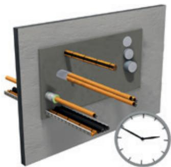
6. Schottschild deutlich (!) mit einem Permanentmarker ausfüllen und dauerhaft neben (nicht auf) dem Schott einseitig anbringen.
