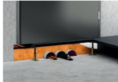
3. Stopfen zuschneiden und mit FLAMMOTECT-A versiegeln (Trockenschichtdicke  $\geq 1$  mm). Bei Belegung mit EIR (Elektroinstallationsrohren) ohne Kabelbelegung sind die Öffnungen der EIR mit Mineralwolle zu verstopfen und anschließend mit FLAMMOTECT-A zu versiegeln.
